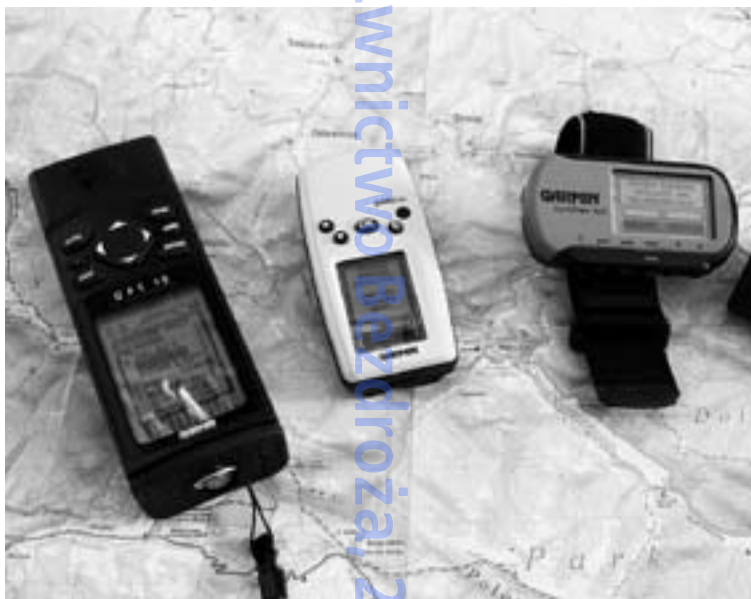
GPS – urządzenia ręczne (od lewej): Garmin GPS 12 XL, Garmin Geko 201, Garmin Foretrex 101.
